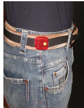
Figuur 2. Zo draag je de versnellingsmeter
