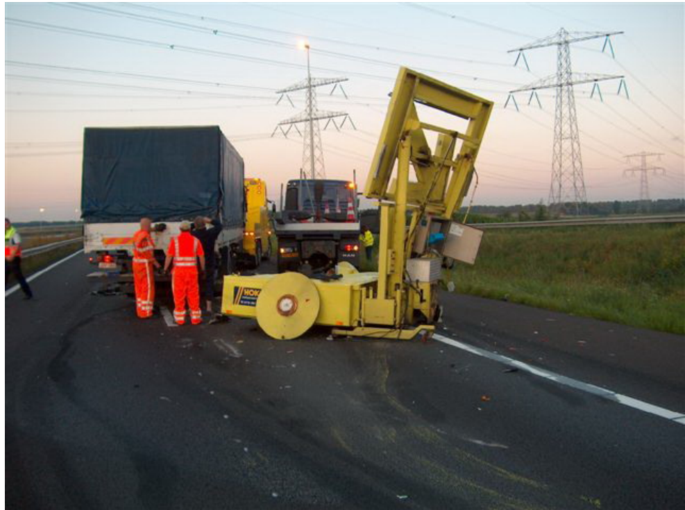
Afbeelding 1.2: Plat gereden botsabsorber
