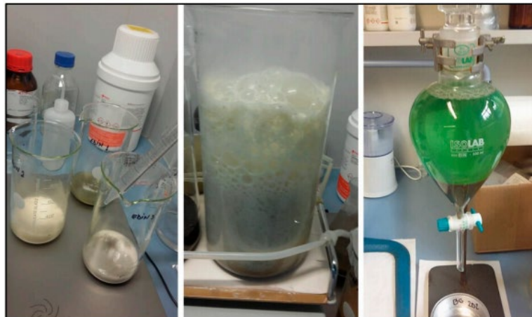
Figuur 7 Voorbeeldopstellingen voor de degradatie (links en midden) en dichtheidsscheiding (rechts) voor de verwijdering van organische en anorganische componenten. Afbeelding overgenomen van bron (Campanale C., 2020).
