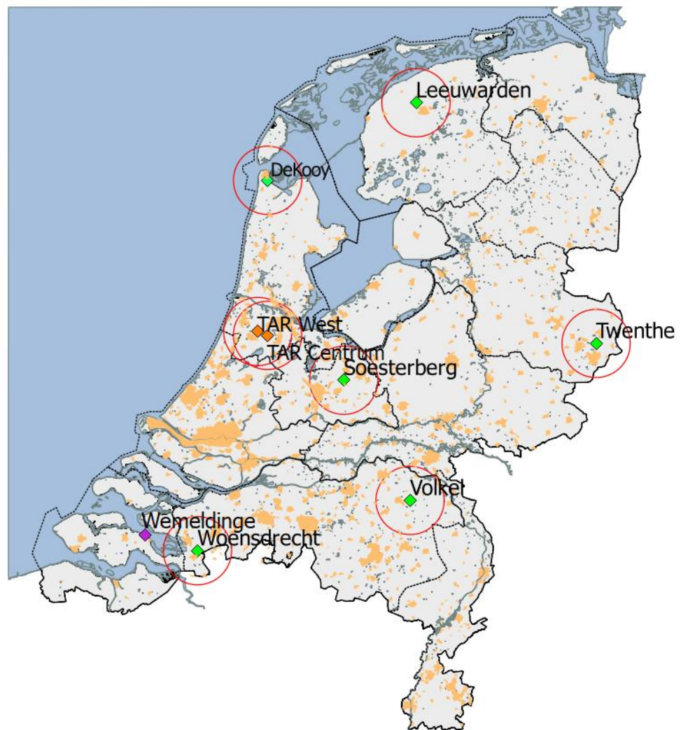
Figuur 14: De locaties van de zes MASS verkeersleidingsradars (groene ruit), de TAR West en TAR Centrum bij Schiphol (oranje ruit) met daaromheen de 15 km cirkels. De Scanner 4002 infill radar bij Wemeldinge (paarse ruit) beschikt niet over secundaire radar en heeft daarom ook geen eigen 15 km cirkel.
