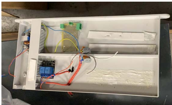
Figuur 30 3d geprinte hoes van het accupakket, deze is volledig in de deur geïntegreerd.
