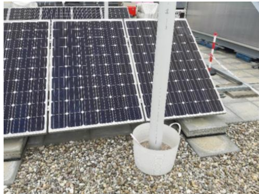
Figuur 2.23. Positie van het paal schaduw element.
