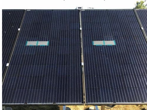
Figuur 2.17. 50% schaduw op 2 cellen per zonnepaneel op verschillende substrings, beschaduwning op 2 zonnepanelen per systeem.
