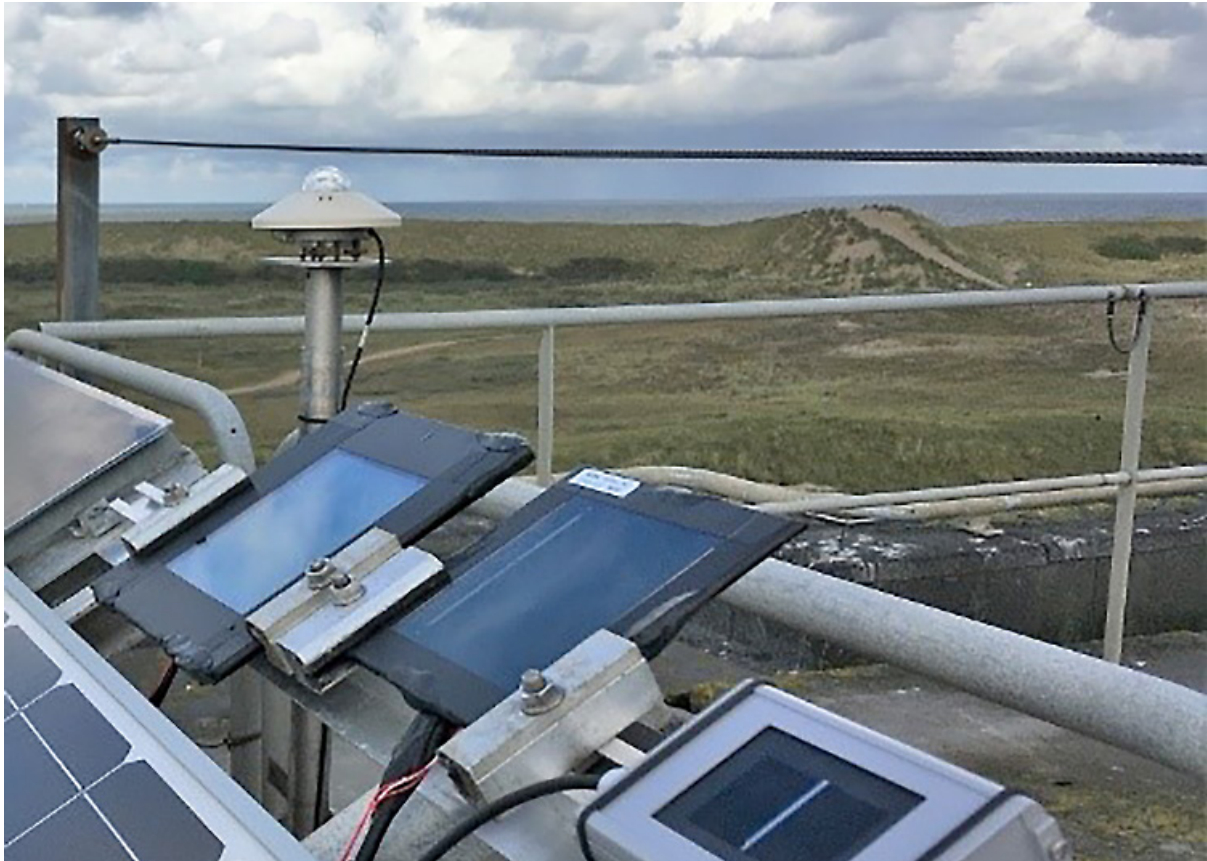
TANDEM MINIMODULES IN DE BUITENTEST.
