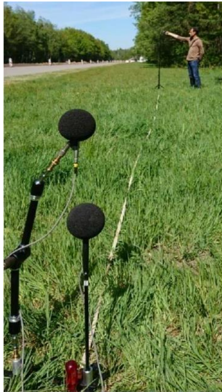
Figuur 31 Meetopstelling met 2 microfoons en een startpistool voor de bodem-impedantie metingen. Locatie: gras aan overzijde van de weg en scherm/Whiswall.
