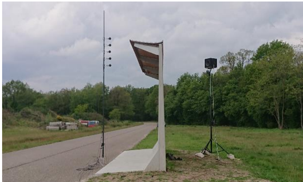
Figuur 1 Impressie van de diffractietest metingen op een 4 meter hoge wand, met een luidspreker op 2 meter afstand en 5 microfoons op 2 meter achter de voorzijde van de Whiswall.
