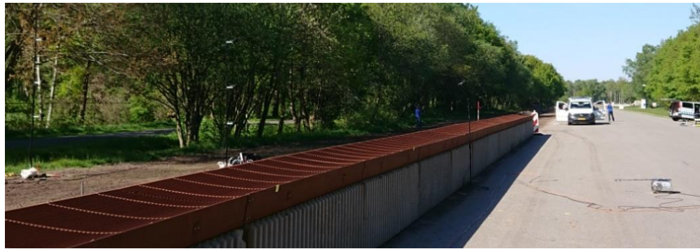
Figuur 3 Impressie van de metingen met een kunstbron (luidspreker) voor de Whiswall en microfoons op 5 en 10 meter achter de Whiswall, op 1,2 / 2,0 / 3,0 en 5,0 meter hoogte.
