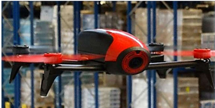
Figuur 6: Inzet van een 5G-empowered drone voor Drone Cycle Counting [60]
