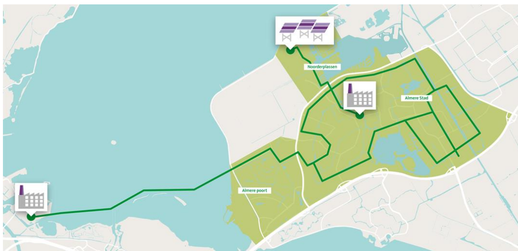
Figuur 3.9 Het warmtenet in Almere. Het gearceerde deel geeft het leveringsgebied van Vattenfall weer.
