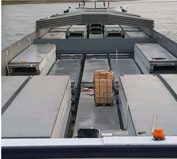
Figuur 12: Vervoer van vloerplaten over water (bron: NPRC)
