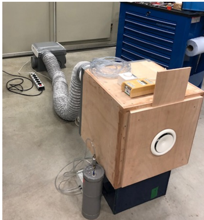
figuur 20: Meetbox met ventilator voor het demonstreren van de ATT.
