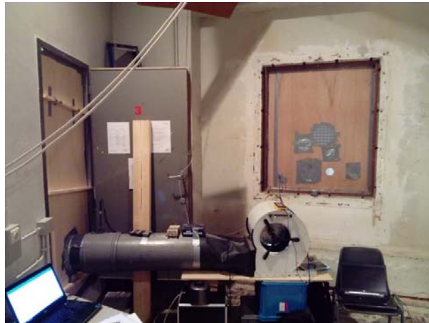
figuur 16: Blowerdoor set van TNO in transmissiekamer TU Delft.
