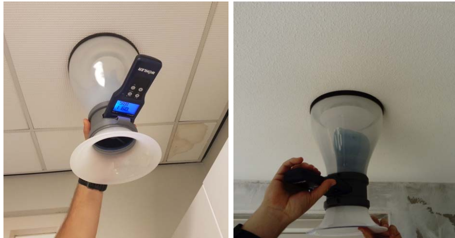
figuur 65: Plaatsing van de VentiFlow-mk2 over het ventiel.
