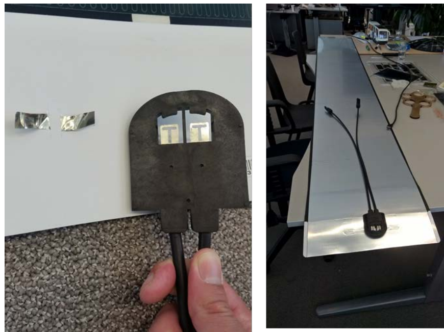
Figuur 9: Montage junction box aan de onderzijde van de MiaSolé module
