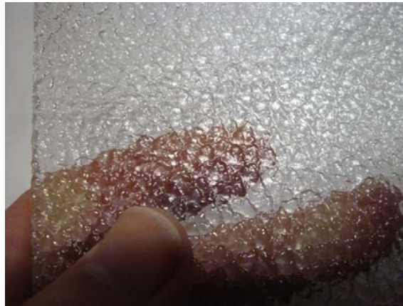
Figuur 30: Materiaalstructuur 3 mm polycarbonaat afdekkap
