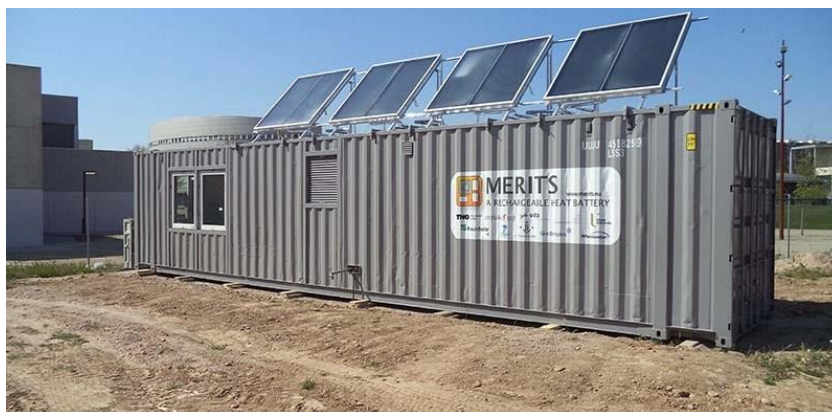
Figuur 4.1: Veldtestopstelling met zonnecollectoren op het dak, waarbij de warmte van de collectoren wordt opgeslagen in een prototype warmtebatterij die zich in de container bevindt.
