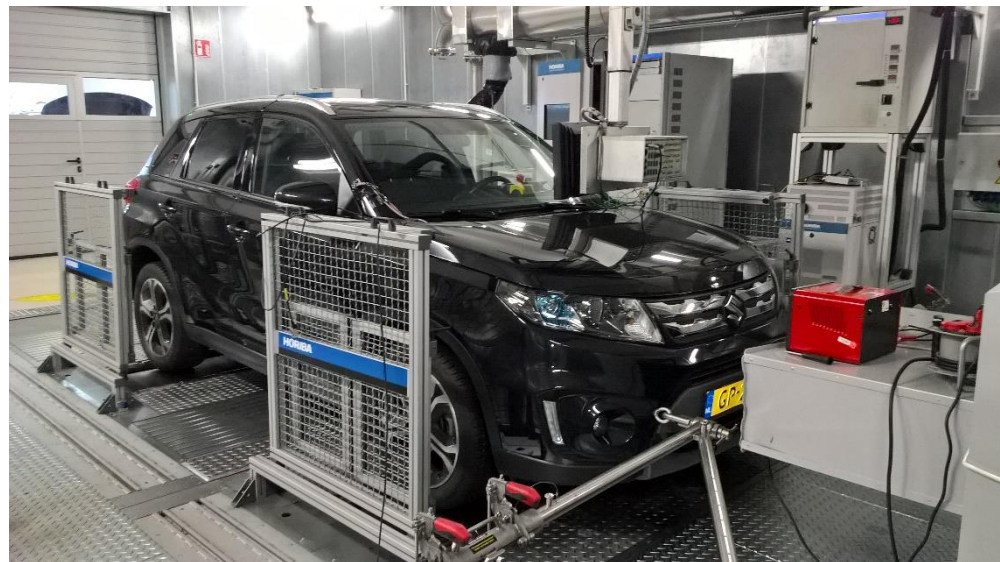
Figuur 2-1: Een Suzuki Vitara op de rollenbank.
