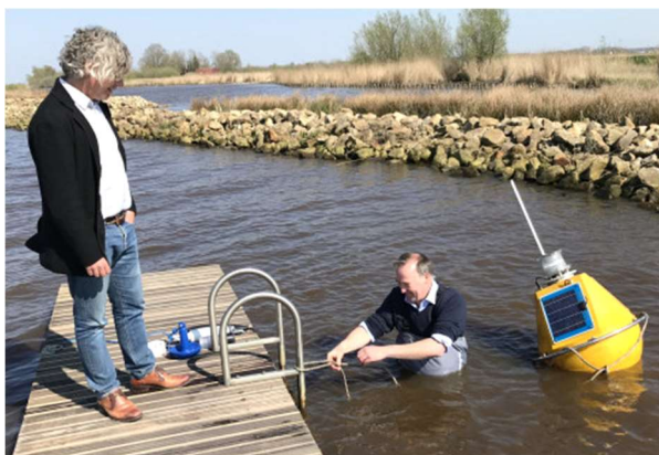
Figuur 9: Links op de steiger de nieuwe en in het water de bestaande sensor [bron: Economic Board Groningen]
