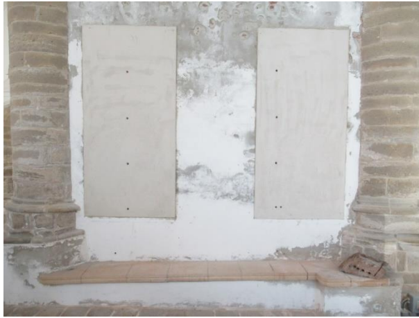
Fig. 10. Proefvlakken met en zonder inhibitor in de Oude Kerk in Brouwershaven.
