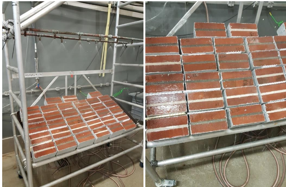
Fig. 8. Beregeningsopstelling in het TNO MEC-laboratorium, gebouwd voor het onderdeel Herhydrofoberen.
