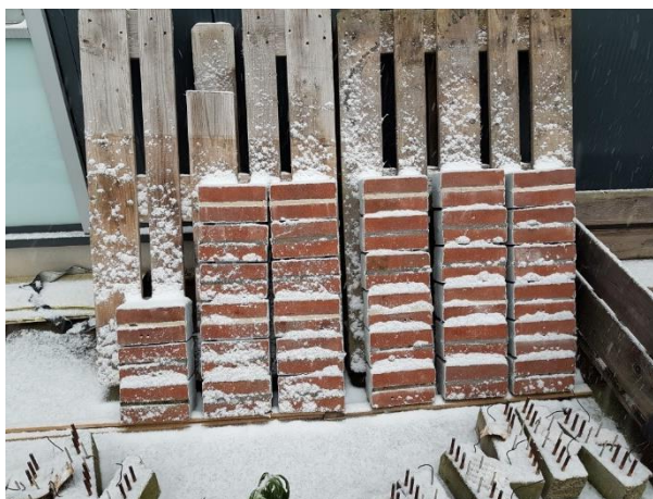
Fig. 9. Proefmuurtjes onderdeel Herhydrofoberen in buitenexpositie achter het TNO MEC-laboratorium.
