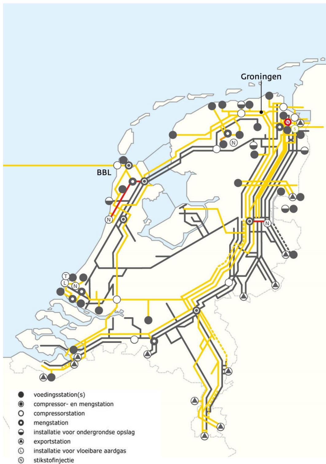
Figuur 2.3 Schematische kaart van het leidingensysteem van GTS*
