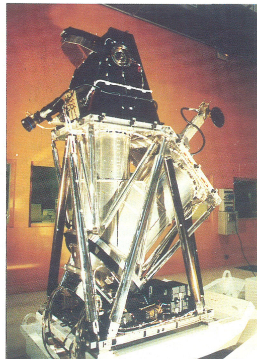
Figuur 4. De hoge-resolutiecamera van de Franse SPOT satelliet. Dit is het eerste 'pushbroom' instrument dat in een operationele missie zal vliegen. Het is tevens de eerste aardobservatiemissie met een stuurbare zichrichting. De satelliet draagt twee identieke camera's die met de bovenaan zichtbare richtspiegel onafhankelijk kunnen worden gericht. (Foto: MATRA ESPACE, Toulouse) (Artikel Hammerschlag, pag. 97)
