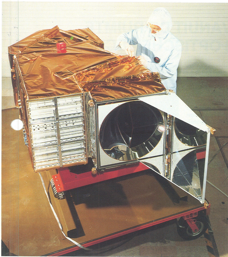
Figuur 3. De Landsat-D Thematic Mapper. Dit is het meest geavanceerde aardobservatie-instrument dat met een mechanische scanspiegel werkt. Het grote voordeel van deze opzet is dat met één instrument zowel het zichtbare- als het infrarode deel van het spectrum kan worden waargenomen. Op de voorgrond is de zogenoemde passieve stralingskoeler te zien. Door afstraling naar de koude ruimte worden hiermede de infrarood detectoren tot circa -200^{\circ}\text{C} gekoeld. De zichtopening bevindt zich rechts achter, bij de elleboog van de technicus. (Foto: Hughes Aircraft Corp.) (Artikel Hammerschlag, pag. 97)
