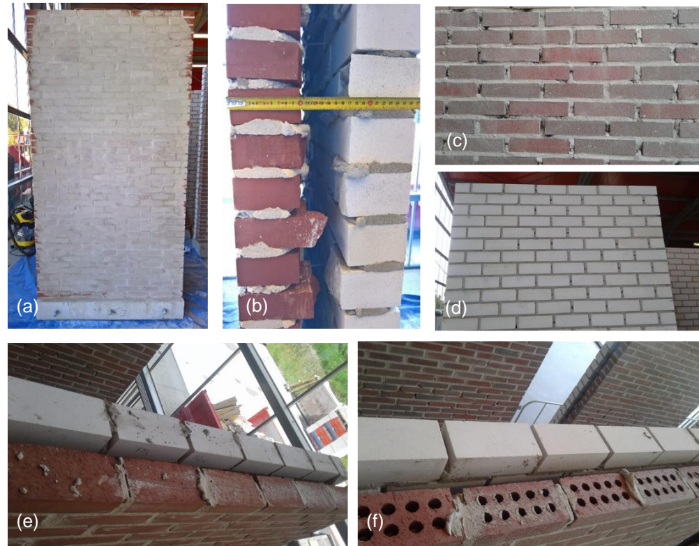
Figuur 11 Detailfoto's van de referentie proefstukken. (a) Het buitenblad na inwassen, (b) zijaanzicht van de spouw, (c) het buitenblad voor inwassen, (d) het binnenblad, (e) de bovenzijde van proefstuk R1 en (f) de bovenzijde van proefstuk R2.
