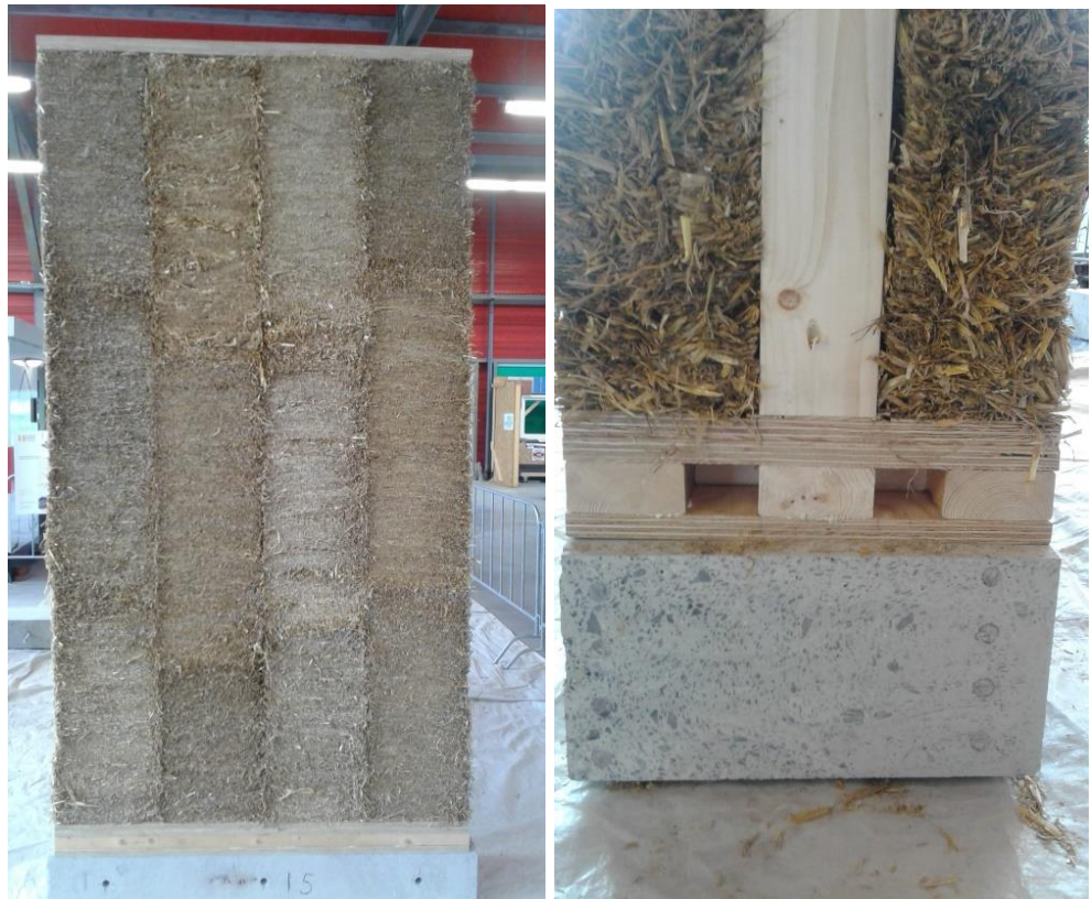
Figuur 13 Vooraanzicht (links) en een detailweergave van het zijaanzicht (rechts) van het Straw Blocks proefstuk.
