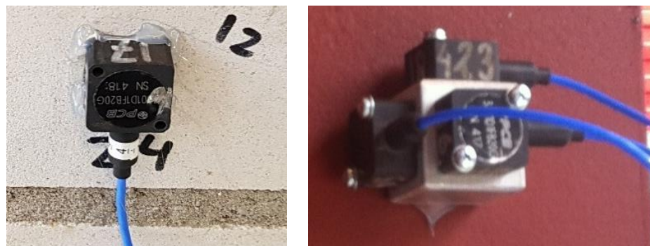
Figuur D.1 detailfoto van een 1D (links) en 3D (rechts) versnellingsopnemer
