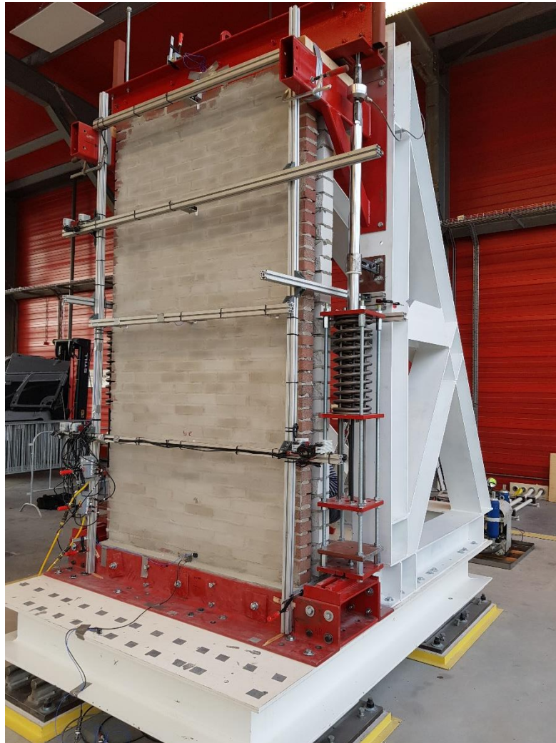
Figuur 12 Het Remix/Strating proefstuk geplaatst op de triltafel.
