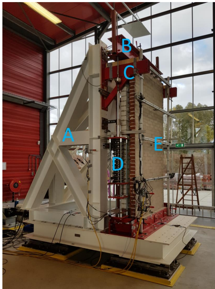
Figuur 6 Overzichtsfoto van de testopstelling met daarin enkele onderdelen uitgelicht: het supportframe (A), de bovenbalk (B), de opvangconstructie voor de bovenbalk (C), de voorspanconstructie (D) en het frame voor de lasers (E).
