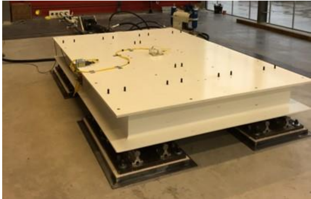
Figuur 5 Uni-axiale triltafel van BuildinG
