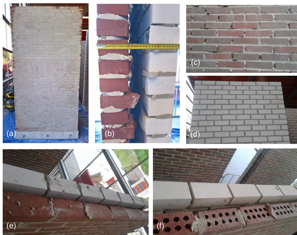
Figuur 10 Detailfoto's van de referentie proefstukken. (a) Het buitenblad na inwassen, (b) zijaanzicht van de spouw, (c) het buitenblad voor inwassen, (d) het binnenblad, (e) de bovenzijde van proefstuk R1 en (f) de bovenzijde van proefstuk R2.
