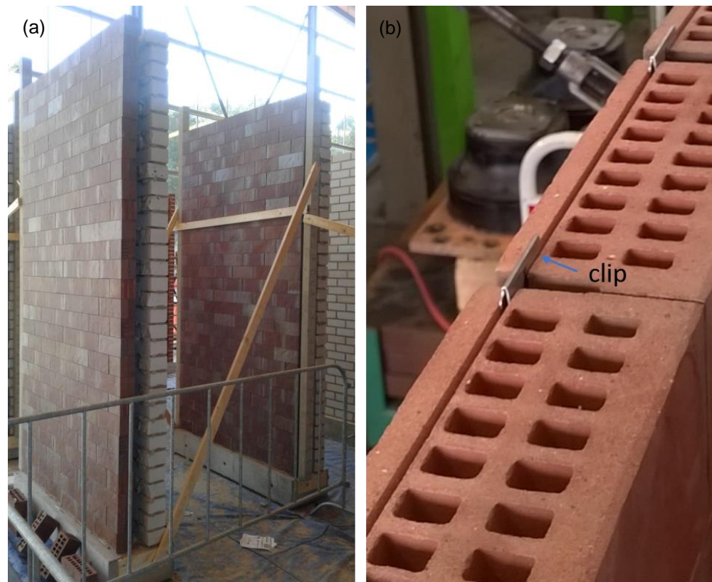
Figuur 12 (a) Foto van de twee ClickBrick proefstukken en (b) foto van de clipjes die worden toegepast tussen de ClickBrick stenen.
