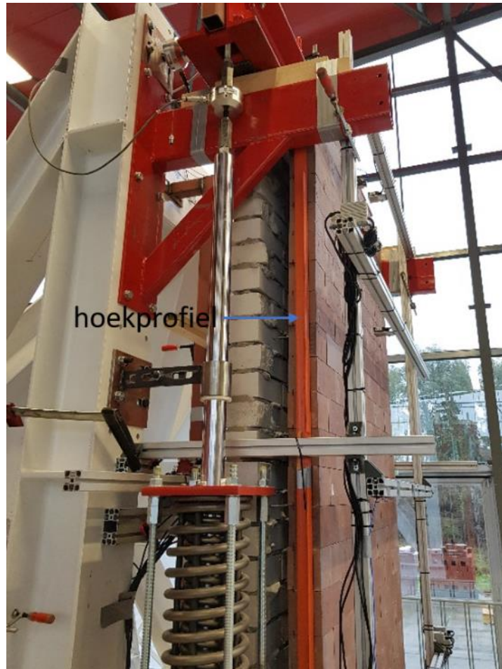
Figuur 13 De blauwe pijl toont het hoekprofiel toegepast aan beide zijden van het ClickBrick buitenblad.
