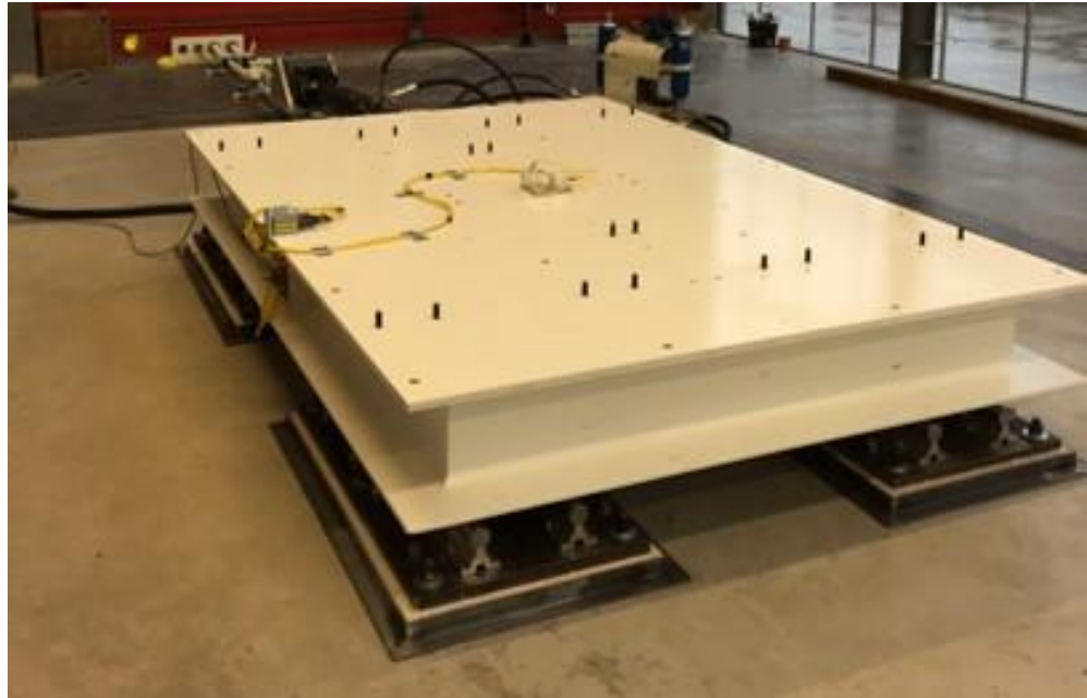
Figuur 5 Uni-axiale triltafel van BuildinG
