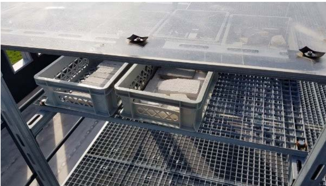
Figuur 35: Expositie buiten beschermt op dak TNO-laboratorium.
