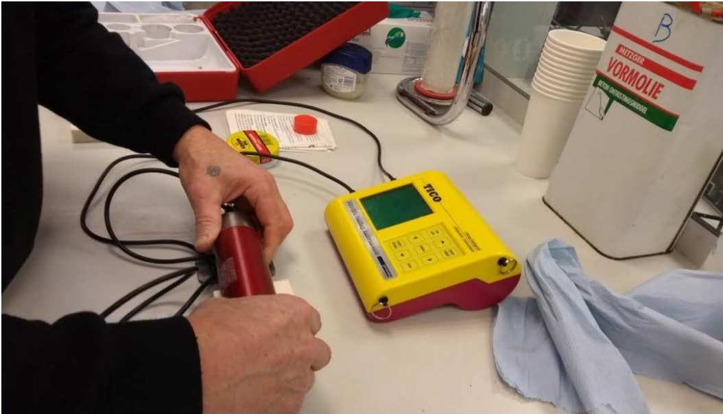
Figuur 37: Kalibreren van het ultrasoon meetapparaat
