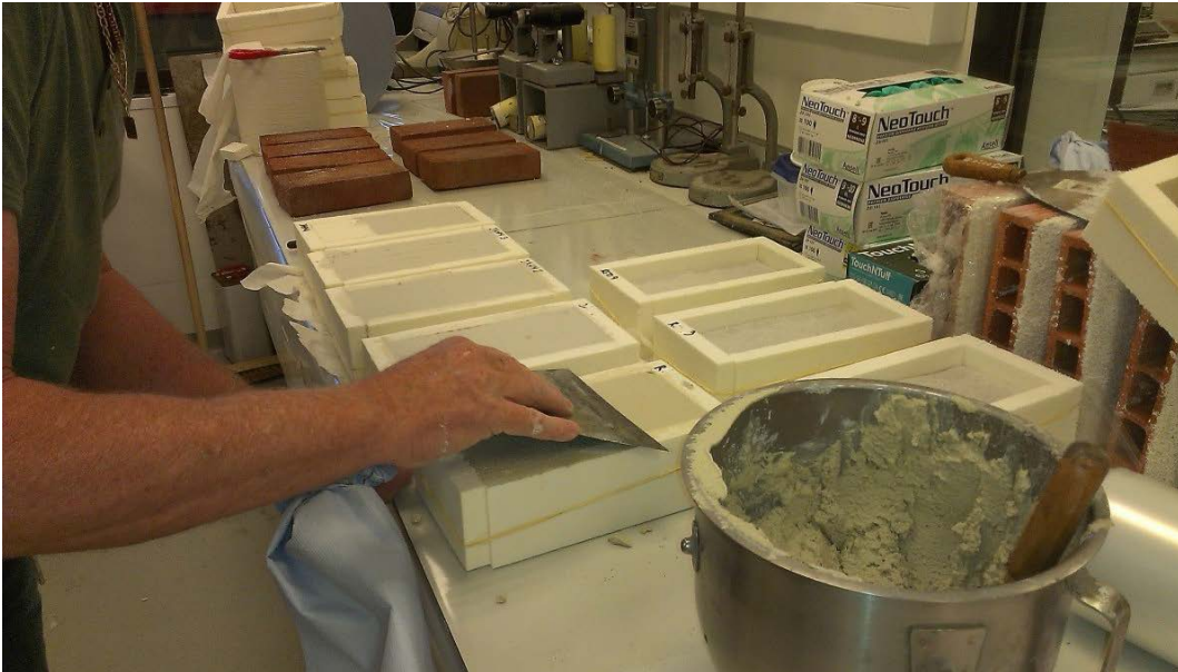
Figuur 34: Maken van proefstukken type b op baksteen ondergrond.
