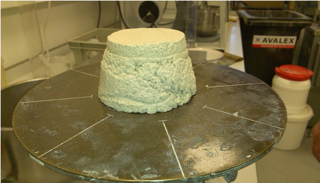
Figuur 33: Meten van de verwerkbaarheid van de mortel volgens NEN-EN 413-2:2016
