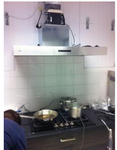
Figuur 2 in het TNO Indoor Air Quality lab experimenteel bepaalde vangst efficiëntie vergeleken met CFD resultaten (bron: TKI KEEK).
