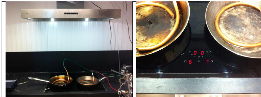
Figuur 20 positie pannen op fornuis, CO 2 injectie buis en instelling kookplaat.
