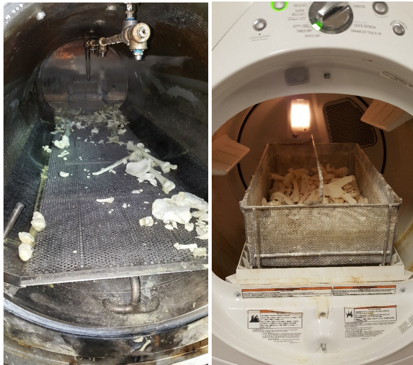
Figuur 8 Overblijfselen van het resomatieproces; in de resomator (links); in de droger (rechts).
