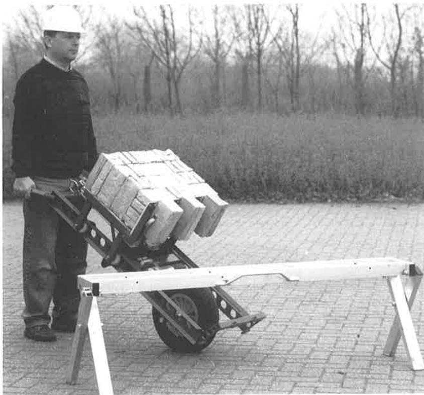
Met de opkar in een keer vijftig stenen oppakken en afzetten.
