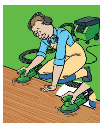
Schuren (excenter) met afzuiging Preventiefactor (PF): 150 - 300 maal
