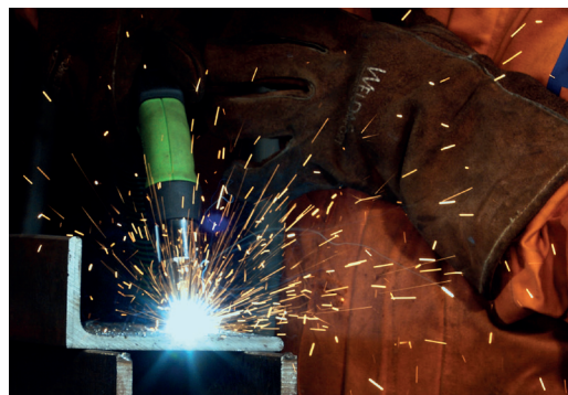
Innovatieve lastoortsen. Links: lassen met een lastoortsen zonder toortsafzuiging. Rechts: lastoortsen met bronafzuiging.
