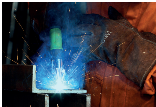
Innovatieve lastoortsen. Links: lassen met een lastoortsen zonder toortsafzuiging. Rechts: lastoortsen met bronafzuiging.
