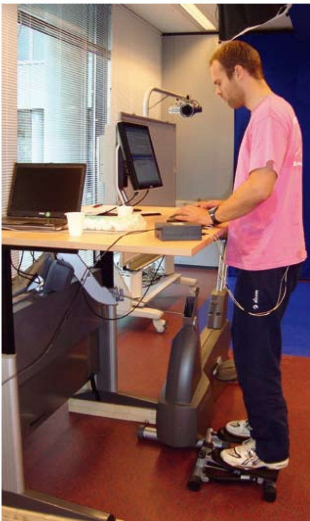
Figuur 1. Experimentele opstelling met beeldscherm, toetsenbord en muis op een verhoogde tafel. Links is de conditie steppen zichtbaar, rechts de conditie fietsen
