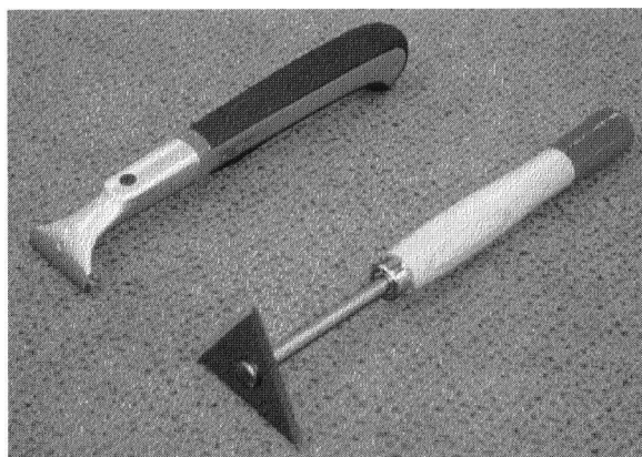
Figuur 1: Nieuwe verfkraabber en de traditionele driehoek verfkraabber
