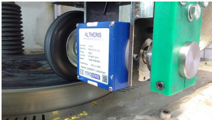
Figuur 2: Rolweerstandsmeting op een asfaltplaat
