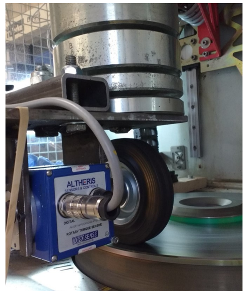
Figuur 3: Rolweerstandsmeting op een staalplaat
