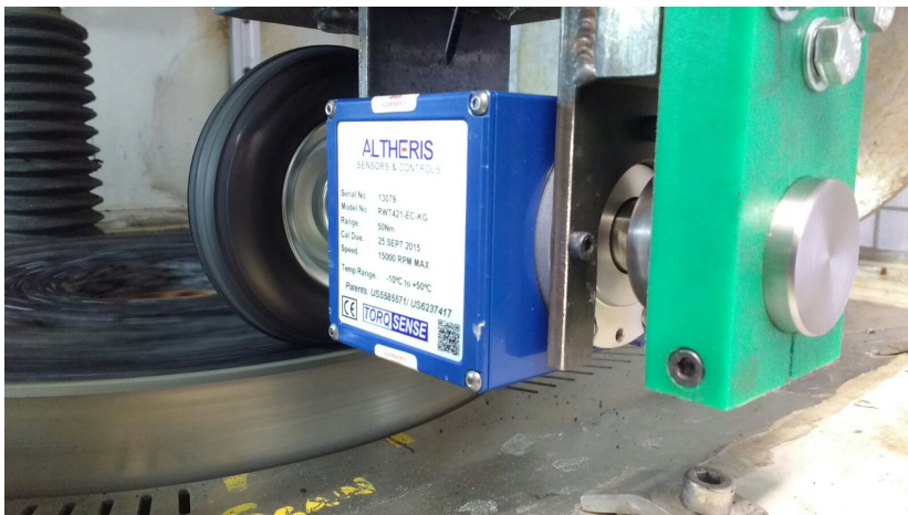
Figuur 2: Rolweerstandsmeting in het laboratorium op een asfaltplaat
