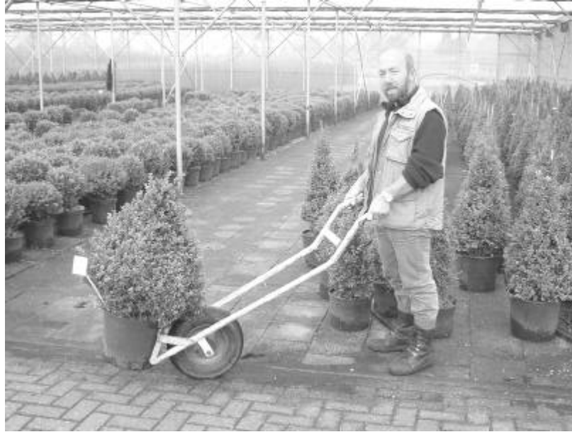
Foto 2. Door één van de SW-bedrijven werd dit karretje ontwikkeld om de lichamelijke belasting bij het oppakken van zware plantenpotten te verminderen
