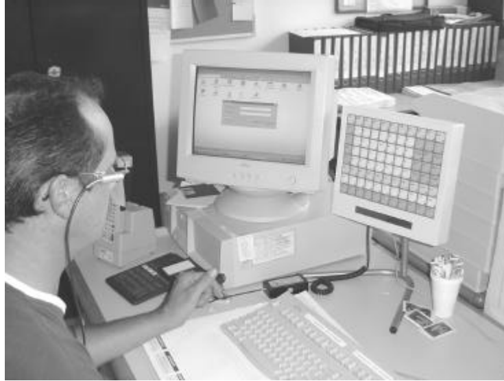
Foto 6. Voor een werknemer met beperkingen in het gebruik van de handen is een alternatief invoermiddel voor computerwerk ingevoerd; het toetsenbord dat naast het scherm staat wordt met een lampje op een bril bediend
