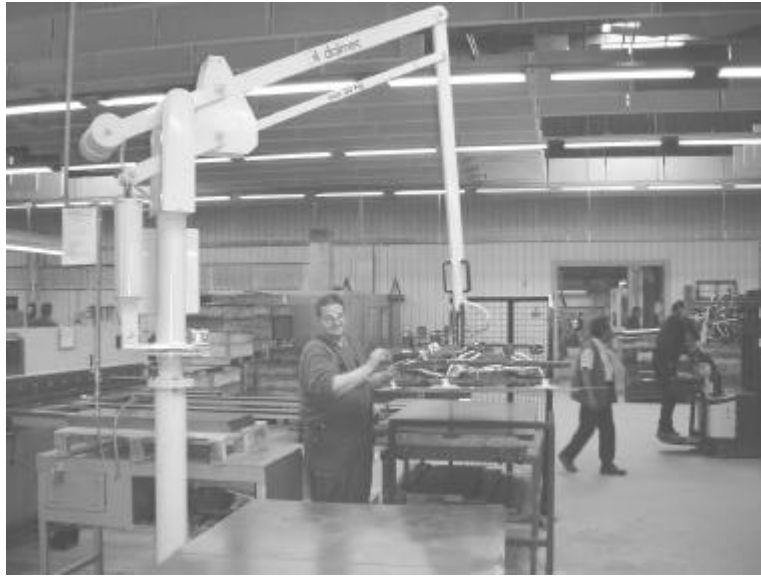
Foto 1 Door het gebruik van een vacuüminstallatie voor het tillen van zware platen wordt het risico van handmatig tillen geëlimineerd
