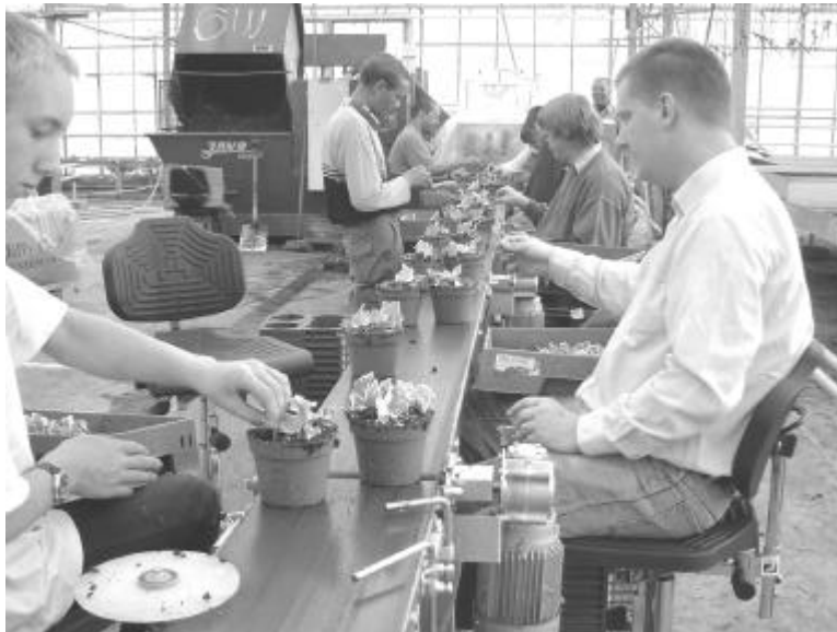
Foto 4. Het werk aan een lopende band kan geschikt gemaakt worden voor zowel zittende als staande taakuitvoering door te zorgen voor een goede werkhoogte en voldoende beenruimte voor aanschuiven van stoelen of stasteunen
