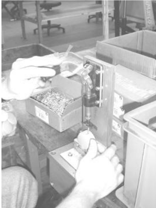
Foto 3. Door gebruik van een mal voor plaatsing van een schroefje hoeft de werknemer minder voorover te buigen; om het gewenste effect te bereiken moet de werknemer wel goed voorgelicht en begeleid worden
