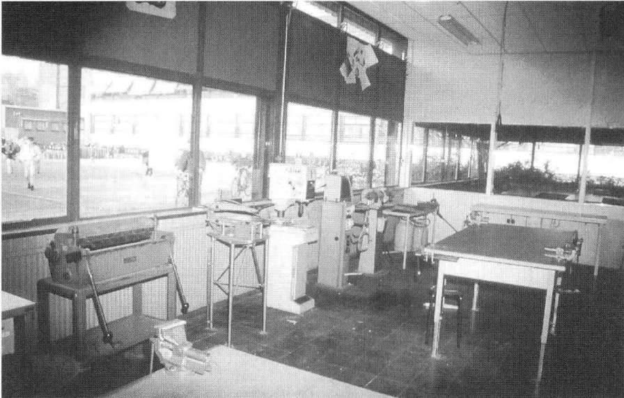
Een goede opstelling met voldoende werk- en doorloopruimte
