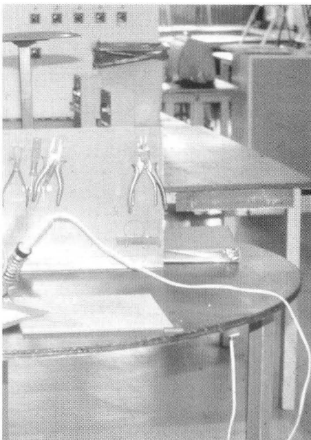
Contactdozen zijn vooraan, onder de tafel gemonteerd, zodat de soldeersnoeren van de tafel afhangen
