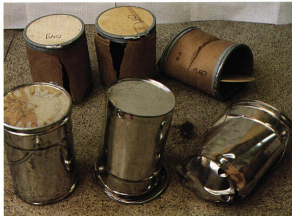
Schade aan verpakkingen ten gevolge van een val van 12 m hoogte.
