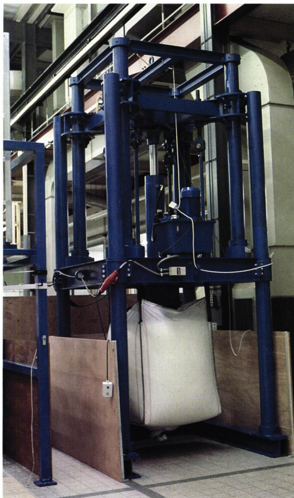
Trekbank voor de beproeving van flexibele IBC's
