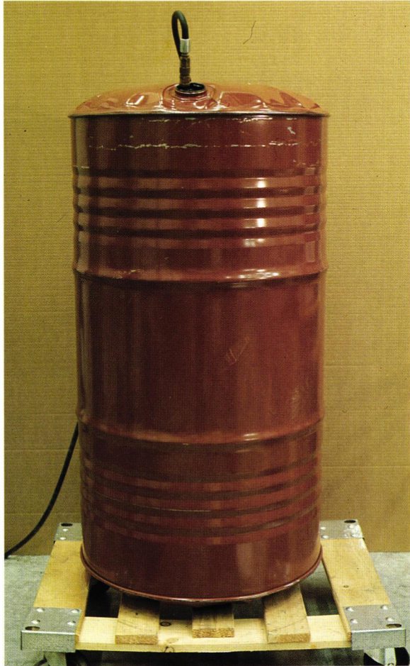
Vervorming van een stalen vat ten gevolge van toename van de inwendige druk
