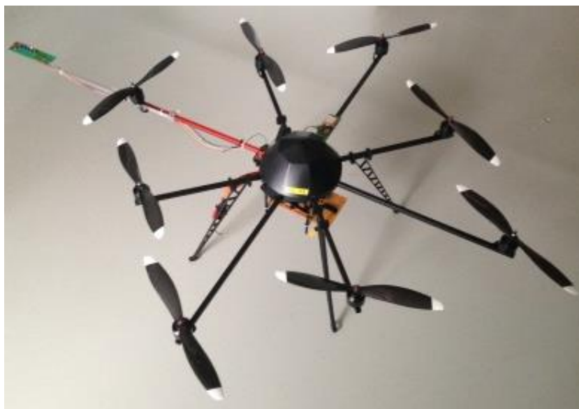
Figuur 12 Mikrokopter Okto met Chemische sensor.
