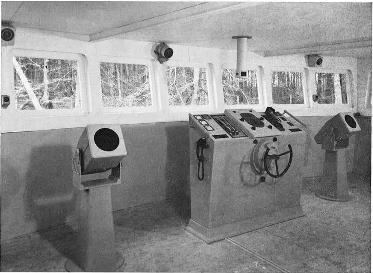
Fig. 1. Gedeeltelijk overzicht van een bouwmodel op ware grootte van de brug van een loodsboot.
