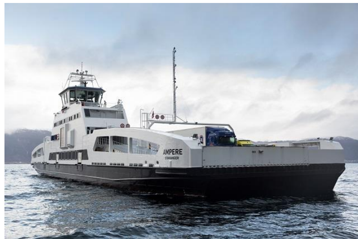
Figuur 15: Volledig elektrisch autoveer tussen Lavik en Oppedal (N). Vaarafstand 5,6 km en benodigde energie circa 150 kWh per enkele reis.
