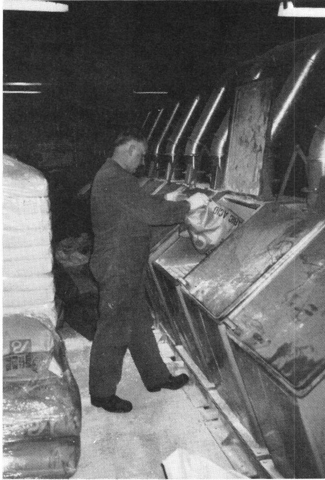
Figuur 1 Handmatig bijvullen van de silo's met chemicaliën. Om het lopen met de zware zakken te beperken zijn de pallets dichtbij de silo's opgesteld
