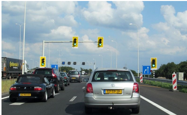
Figuur 2 Toeritdoseeringsinstallatie bij de Uithof in Utrecht (foto: Wikipedia).
