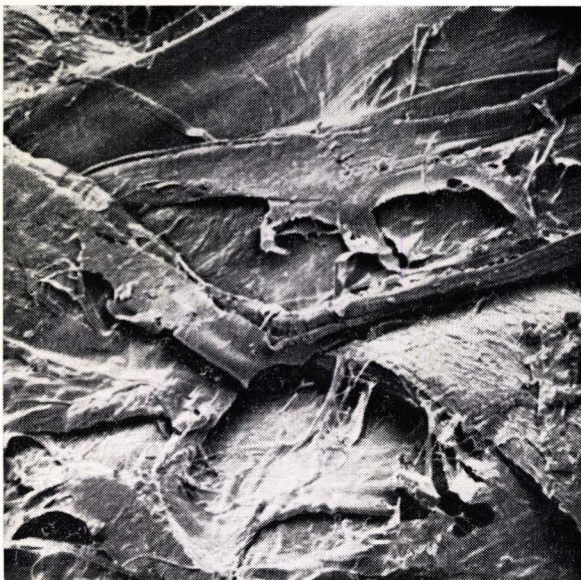
Fig. 18. Vezelbinding in pakkapieroppervlak. Vergr. 1100 ×.
