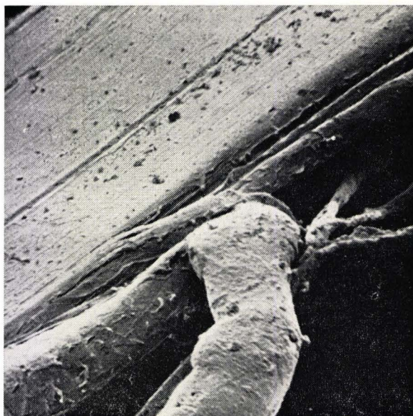
Fig. 23. Filmtextuur in polypropreenfilm. Vergr. 1000 ×.
