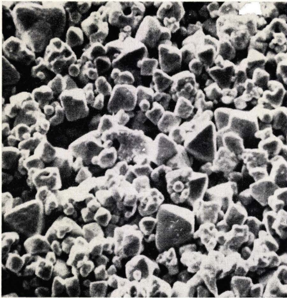
Fig. 24. Pigmentkorrels. Vergr. 5000 \times .
