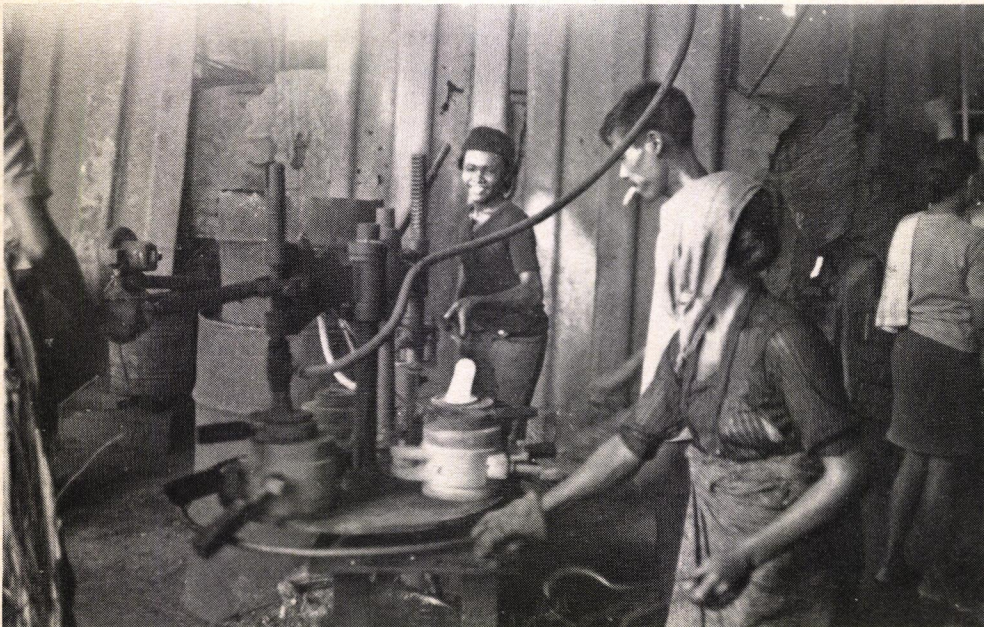
Figuur 2. De glasdruppel wordt in de metalen vorm gebracht en vervolgens met perslucht uitgeblazen tot fles
