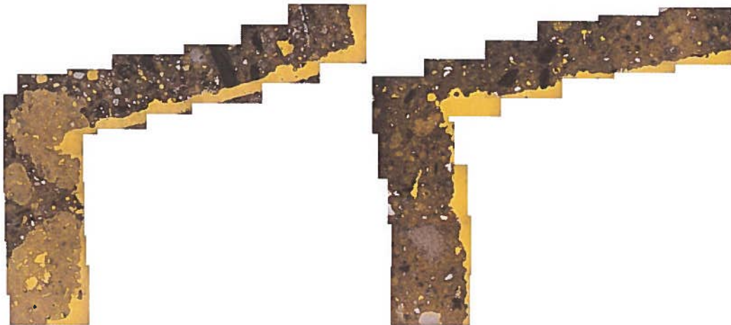
Fig. 7. Samengestelde microfoto's van de aansluiting tussen neus en lijf van behakte montants van Ettringer (links) en Weiberner tuf (rechts).
