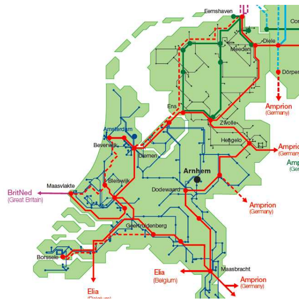
Figuur 3 Landelijke 380/220 kV en 150/110 kV
