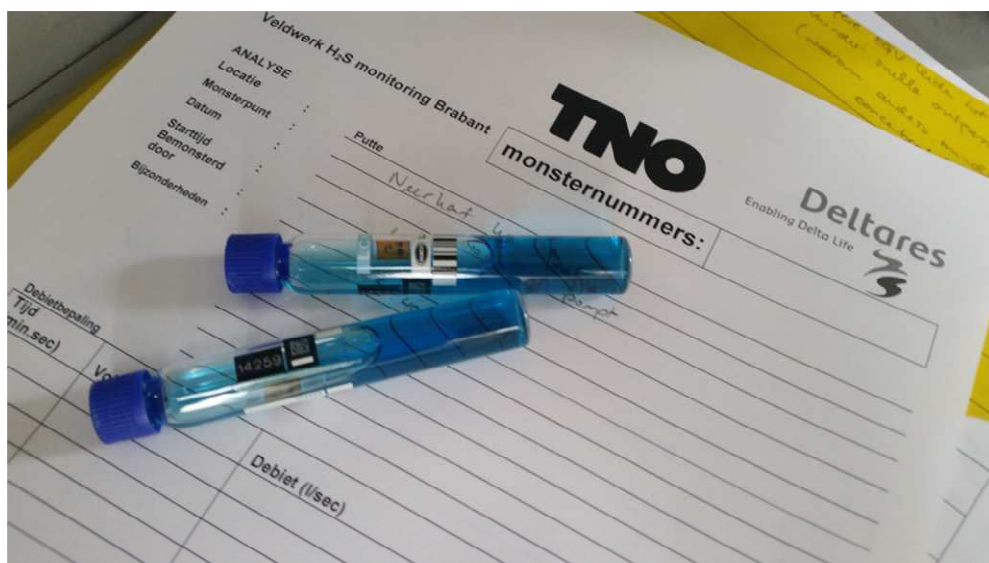
Figuur 4.8. Sterke blauwkleuring na toevoeging van reactanten wijst op een zeer hoge sulfideconcentratie in het water. De blauwkleuring wordt met de veldfotospectrometer gemeten en omgezet in een meetconcentratie in \text{mg S}^{2-}/\text{L} .
