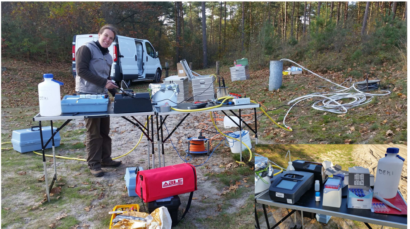
Figuur 3.1. Bemonstering van de provinciale meetnetput in Putte, westelijk Noord-Brabant. Op de tafel is het witte 10 litervat te zien dat als doorstroomcel diende en waar in de headspace met de H_2S monitor de concentratie in lucht werd gemeten onder een gasdicht membraan. Rechts onder de apparatuur voor het on-site meten van sulfaat en sulfide.
