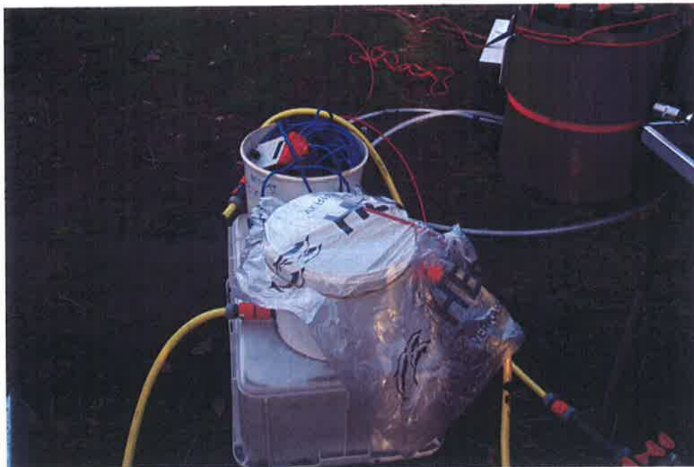
Figuur 3.1. Bemonstering van CH 4 in lucht voor isotopenonderzoek in Vlierden voor Brabant Water (maart 2014). Wateraanvoer gebeurt door de slag links, het vat loopt over via de slang rechts die een hogere uitstroomopening heeft. Methaan en methaanisotopen worden gemeten met de rode aanzuigslang die onder het plastic zichtbaar is. De opstelling is effectief, maar zal voor het onderzoek worden geprofessionaliseerd met een gasdicht membraan aan bovenzijde.
