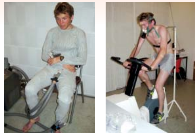
Fig. 5 Een proefpersoon in een watergekoeld pak voorafgaand aan de inspanning in de warmte (links) en tijdens de belastingsperiode (rechts).
