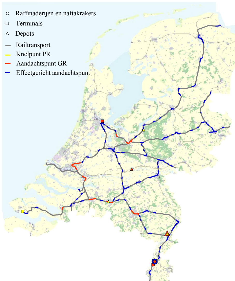
Figuur 8-4 PR-knelpunten en GR-aandachtspunten huidig LPG railtransport in Nederland.
