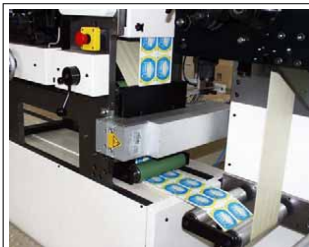
Fig. 32 Toepassing van UV-uithardende drukinkt (Hogedruk kwiklamp met UVA doorlaatfilter) Let op de gele waarschuwingssticker voor monteurs foto Sadechaf UV-Techniek België
