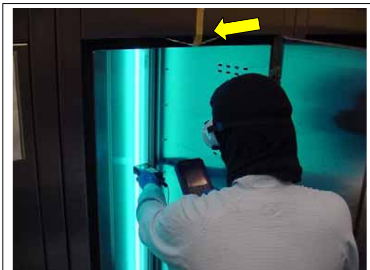
Figuur 31 UV-metingen in een medische droogkast met 254nm UVC lucht- en oppervlaktedesinfectie. Let op de met tape “gefopte” interlock schakelaar (zie pijl), die normaal gesproken de UV-lampen dooft bij opening van de deur. Oog- en huidbescherming is absoluut noodzakelijk bij dit soort werkzaamheden. Onbeschermd is hier binnen enkele minuten de blootstellingslimiet flink overschreden (“gevoel van zand in de ogen”).
