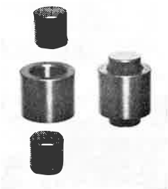
Fig. 2. Stempelapparaat waartussen de stootgevoeligheid van een stof wordt onderzocht volgens de BAM-methode.
