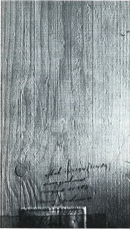
Vochtwisseling in het hout geeft aanleiding tot reliëfvorming aan het houtoppervlak en in het aangebrachte verfsysteem.
