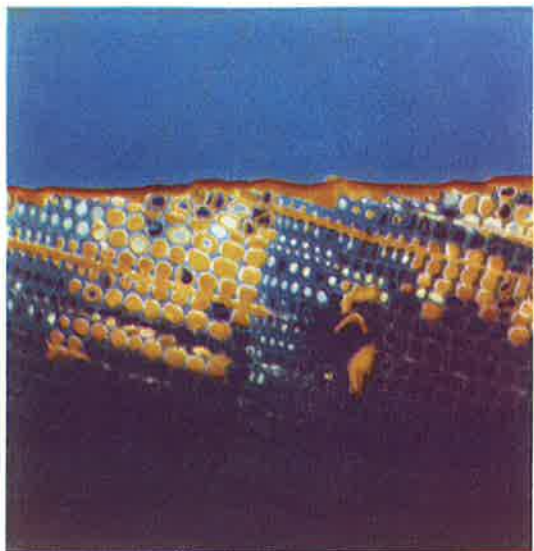
Lijnolie-titaanwitverf op geschaafd greenhout. Pigment + bindmiddel dringt via de mergstralen diep in het voojaarshout; in het zomerhout dringt in de celholten alleen bindmiddel.
