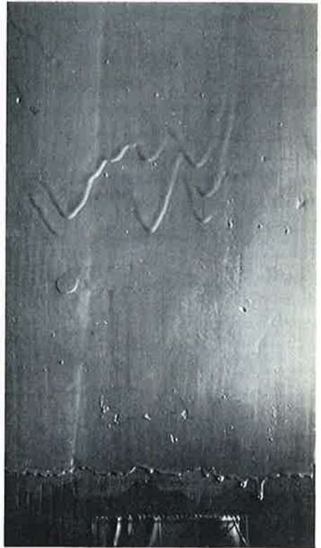
„Zakkers“: verfeigenschappen en aanbrengtechniek zijn te weinig aan elkaar aangepast.
